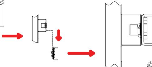
**Remarque :** comme indiqué sur l'image C, les espaces entre les tiroirs peuvent être ajustés avec précision à l'aide des trous ovales situés sur le panneau avant et les rails latéraux.
